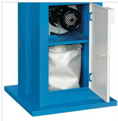
**Absaugung IA-1: Absaugung im Unterbauschrank verbaut**
